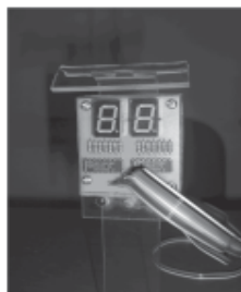
Gambar 17. Rangkaian LED dan rangkaian 7-segmnnet
