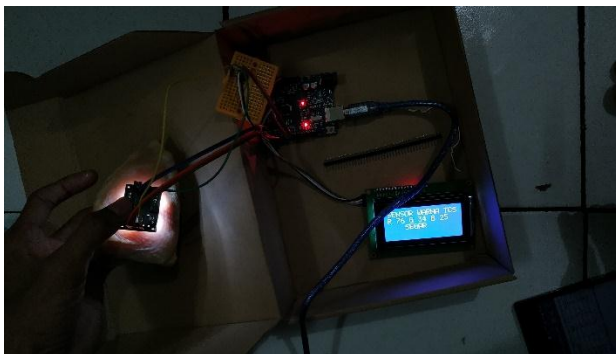
Gambar 8. Pengujian daging segar dengan sensor warna
