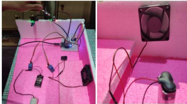
Gambar 6. Tampilan Alat pengujian Sensor MQ-2
