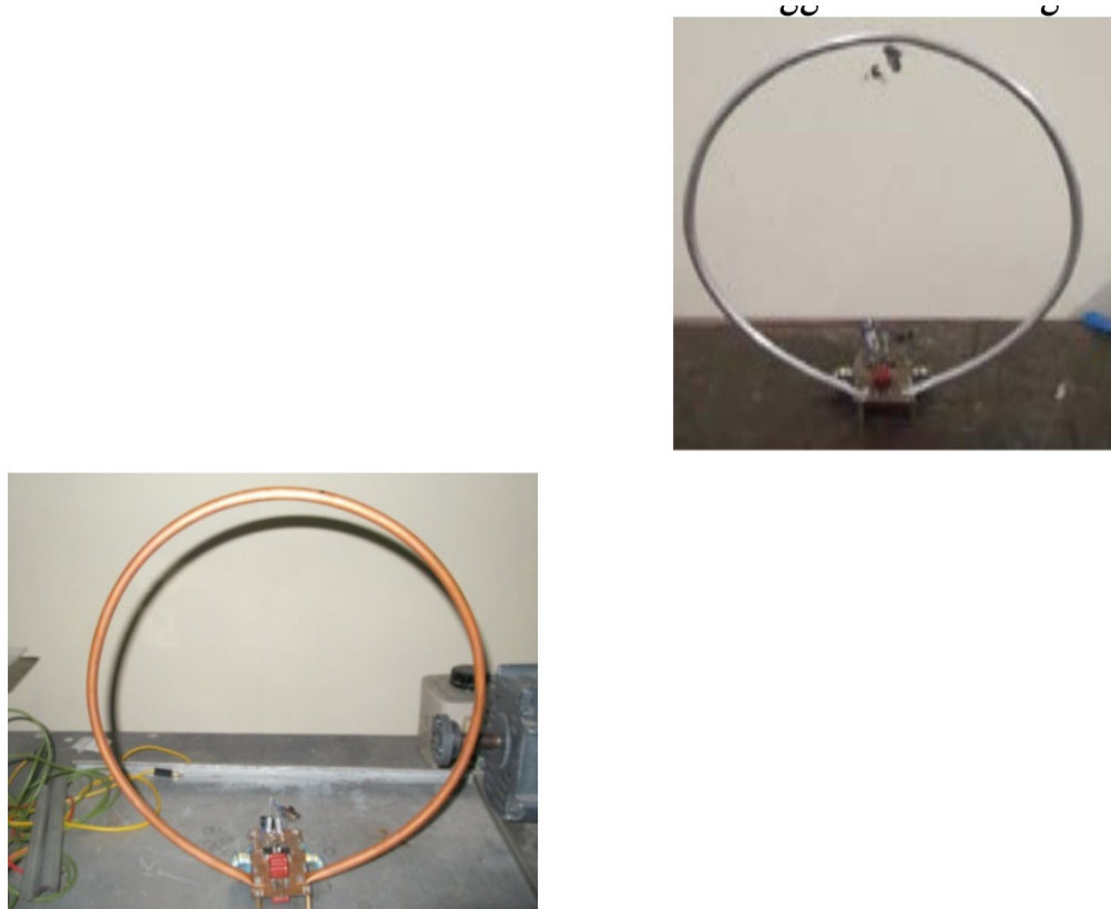
Gambar 8. WPT dengan antenna dari bahan alumunium dan tembaga [11]
