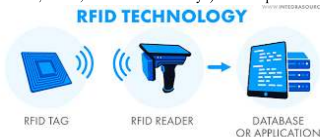
Gambar 3. Alur Kerja Metode RFID
