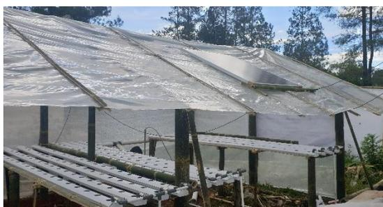
Gambar 9. Sistem hidroponik dengan solar panel di desa Benteng Mamullu Tanah Toraja
